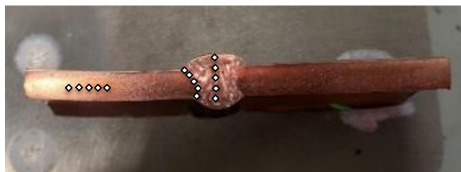
Gambar 2 Spesimen uji kekerasan
