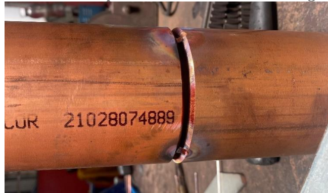
Gambar 2 Bentuk sambungan las
