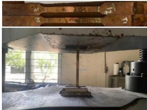
Gambar 1 Spesimen Uji Tarik
