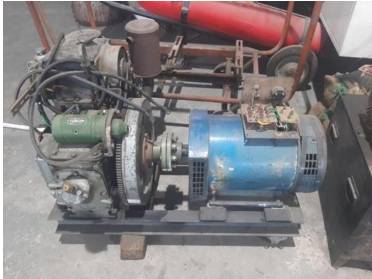
Gambar 2 Diesel Engine Jiangdong ZH1115N dikopel dengan generator
