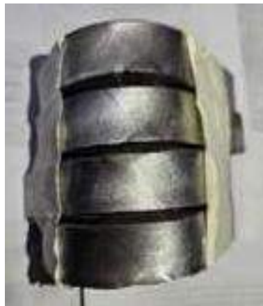
Gambar 4. 1 Hasil Pengamatan Uji Tekuk 80A
