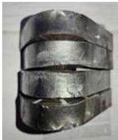
Gambar 4. 3 Hasil Pengamatan Uji Tekuk 80C
