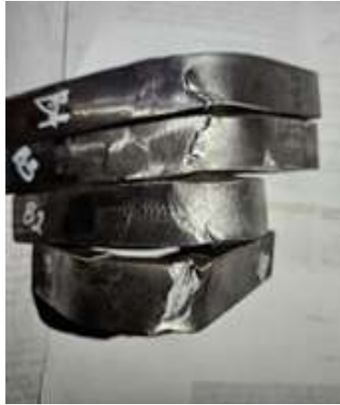
Gambar 4. 5 Hasil Pengamatan Uji Tekuk BFB
