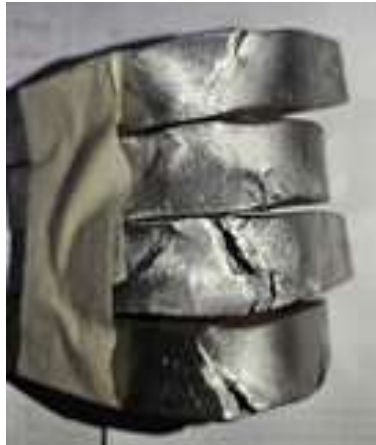
Gambar 4. 4 Hasil Pengamatan Uji Tekuk BFA
