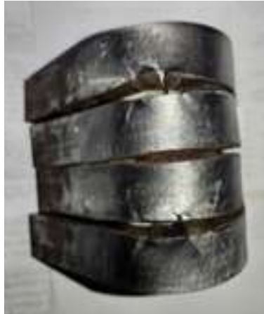
Gambar 4. 2 Hasil Pengamatan Uji Tekuk 80B
